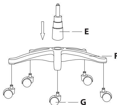
**2** Установка механизма регулировки высоты
